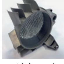
Les procédés de fabrication additive par micro-fusion laser sur lit de poudre métallique ouvrent aujourd'hui la porte vers de nouveaux degrés de liberté pour la conception des pièces, la réduction des frais d'outillages ou de choix des matériaux. Le point de départ étant la CAO, il faut donc concevoir pour ce procédé et non l'inverse.
